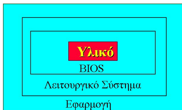
Εικ. 1 Διαγραμματική αναπαράσταση της δομής ενός υπολογιστικού συστήματος
